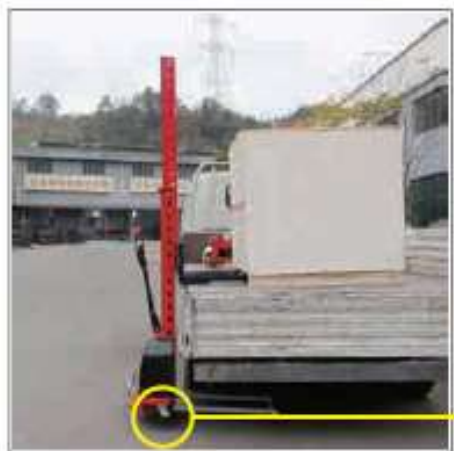
Obr. 12 Lehce zvedněte stojan 5 cm nad zem
