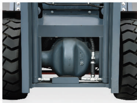
Hnací náprava: Integrovaný brzdový buben, integrovaná litá skříň nápravy, konstrukce s olejovým těsněním v polovině hřídele, vysoce přesné převody
